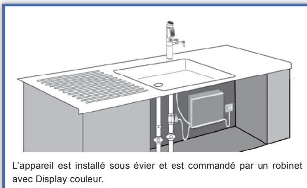
L'appareil est installé sous évier et est commandé par un robinet avec Display couleur.
